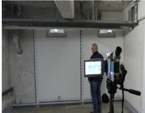
Abbildung 3 (links): Das Monitorbild der hochauflösenden IR-Kamera, die Messung erzeugt eine Datenwolke.
