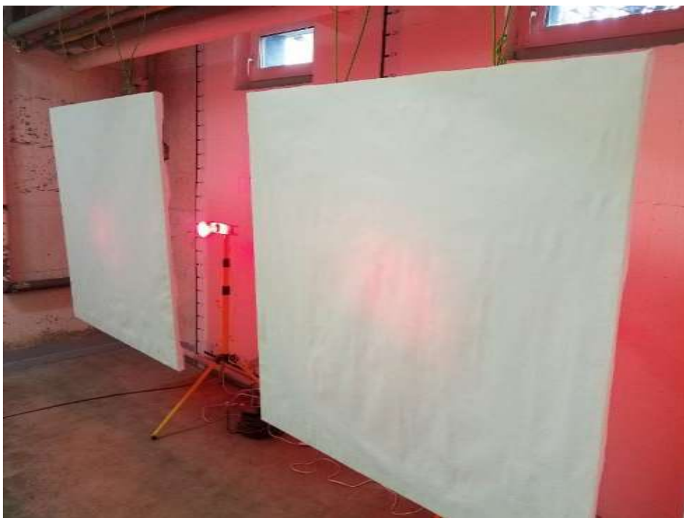
Der Test im laufenden Betrieb, d.h. mit angeschalteten Infrarotlampen. Angestrahlt wird die unbeschichtete Rückseite.
