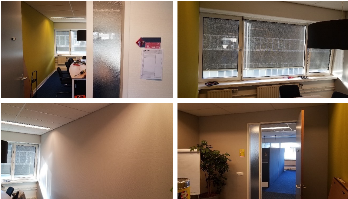
Fotografische Beschreibung des Testraumes A3.12: Gipskartonwände, Teppichbelag, Akustikdecke, ein großer bestuhelter Tisch
