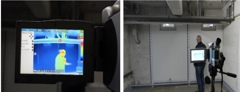
Obrázok 3 (vľavo): Obrázok monitora IR kamery s vysokým rozlíšením, meranie vytvára oblak údajov.
